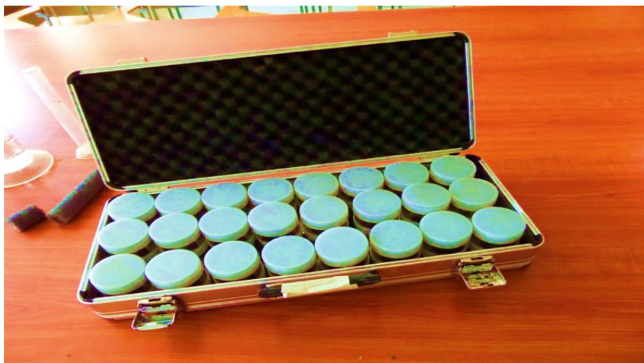
شکل ۲: استوانه‌های نمونه‌گیری در بکس نمونه‌برداری
