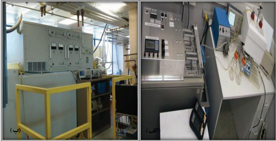
شکل ۴: (الف) دستگاه PEF (OSU 4D، ۶ چمبره کوفیلد، ۱۲kV، ۳۰ L/h) (ب) دستگاه PEF (OSU-6، ۳ چمبره کوفیلد، ۶۰ kV، ۲۰۰۰ L/h) (۸)
