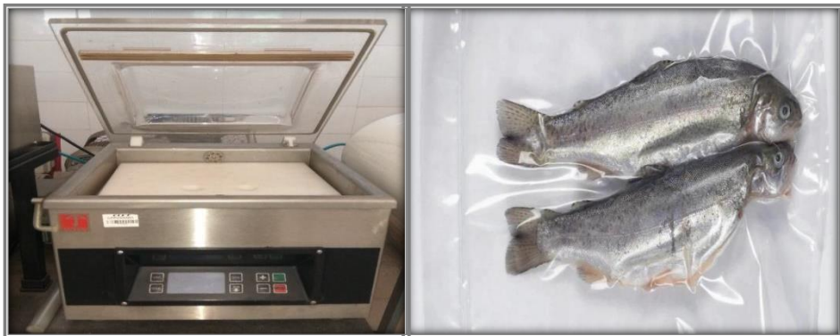
شکل ۲: دستگاه بسته‌بندی واکيوم و ماهی بسته‌بندی شده همراه با بسته‌ی واکيوم
