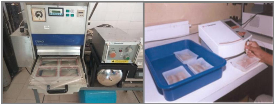
شکل ۳: نمونه از بسته اتموسفیر تغییر یافته همراه با تجزیه کننده گاز
